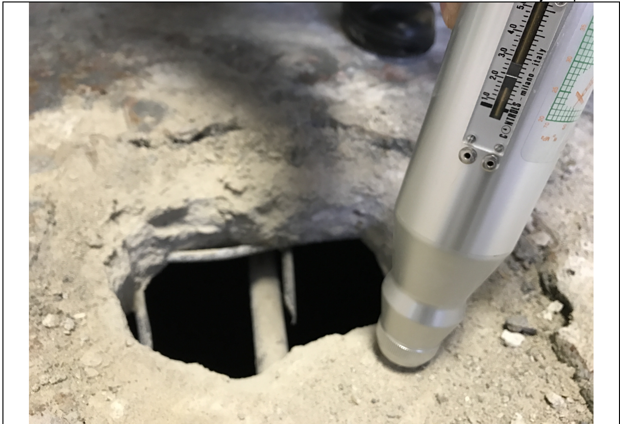
Foto Nr.F03 – Atsegums Nr.1 – monolīta plātne ar stiebrojumu un Šmita āmura nolasiņjums
